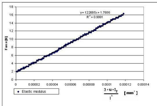
**Fig.11. Longitudinal elastic modulus estimation**
