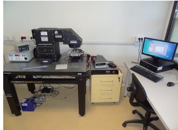
**Fig. 14. Oriel Sol3A solar simulator**
